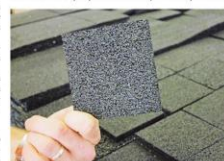
Gumené pláty sa narezú na požadovanú veľkosť. Máť tvorec slúžia ako terčiky pod terasové diaľby.
